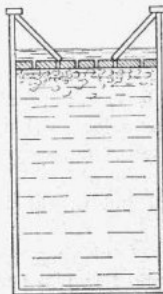
Rys. 23. Fermentacja w miadze; przytrzymywanie „czapki” drewnianą kratką
