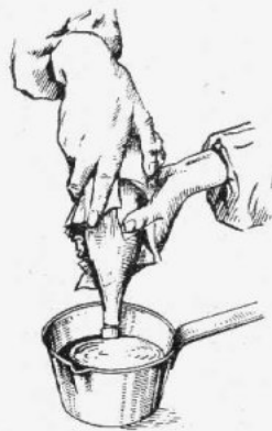
Rys. 42. Sposób pokrycia korka butelki szczeliwem
