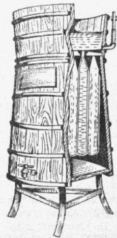
Rys. 40. Filtr holenderski sporządzony z dwóch beczek
