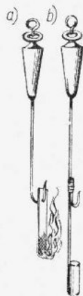
Rys. 33. Czopy do siarkowania naczyń: a) z zawieszonym knotem siarkowym, b) z tygielkiem żelaznym
