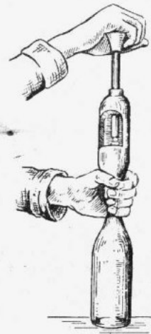
Rys. 43. Sposób korkowania butelek ręczną korkownicą
