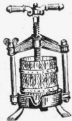
Rys. 21. Prasa śrubowa koszowa (kosz drewniany)
